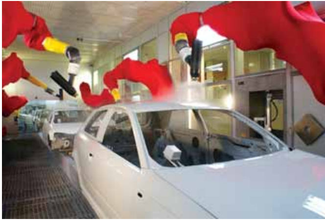
الشكل (٦-٢): الطلاء باستخدام الروبوت.
